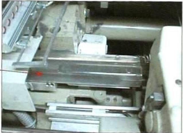
⚠ Peligros derivados del sistema de sujeción y conducción del tejido. Peligro de arrastre o de aprisionamiento entre las cadenas de pinzas o agujas y los piñones.
